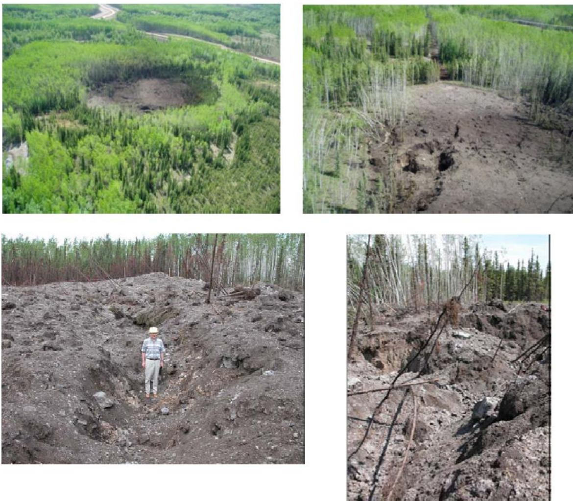
Figura 3. Fotos de la fuga en Joslyn SAGD proyecto. Fuente: Total E&P Canada Ltd. Surface Steam Release of May 18, 2006. Joslyn Creek SAGD Thermal Operation. ERCB Staff Review and Analysis
